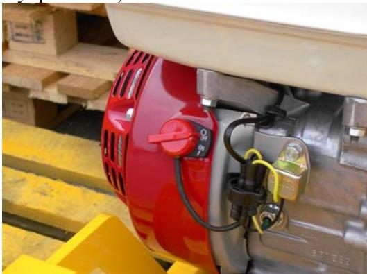
3. Переведите рычаг управления воздушной заслонкой карбюратора в положение «Choke». Делать это можно только в том случае, если вы запускаете остывший двигатель. Запрещается это делать при высоких температурах окружающей среды и при прогретом двигателе.
