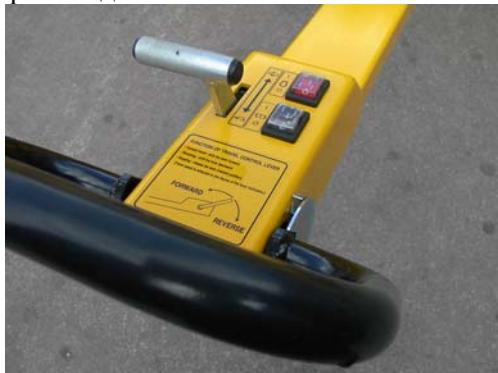
2. Выключите зажигание при помощи клавиши, расположенной на откидной рукояти управления.
